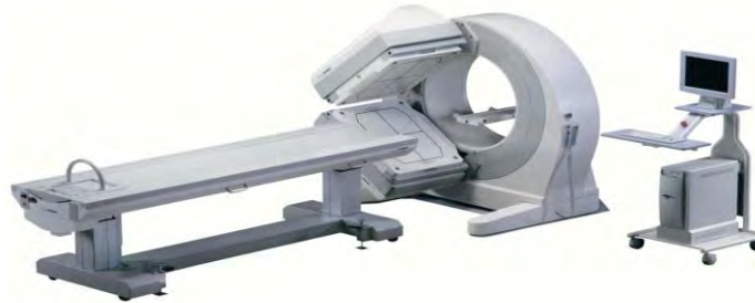
Figure 12 : Gamma Caméra Mediso Nucline TM Spirit DH-V avec sa console d'acquisition dans le service de Médecine Nucléaire de l'Hôpital General Idrissa Pouye de Dakar.
