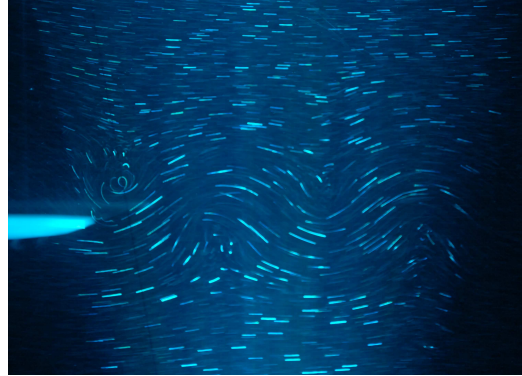
FIGURE 3.13 – Sillage généré par l’aileron rigide forcé avec une amplitude de 0.01 m à une fréquence de 0.7 Hz. L’écoulement incident est à Re = 6000 . Le temps de pose long (8 ms) facilite la visualisation du positionnement des vortex, mettant en évidence le caractère d’un sillage de Bénard-von Kármán inversé, en mode “2S”.
