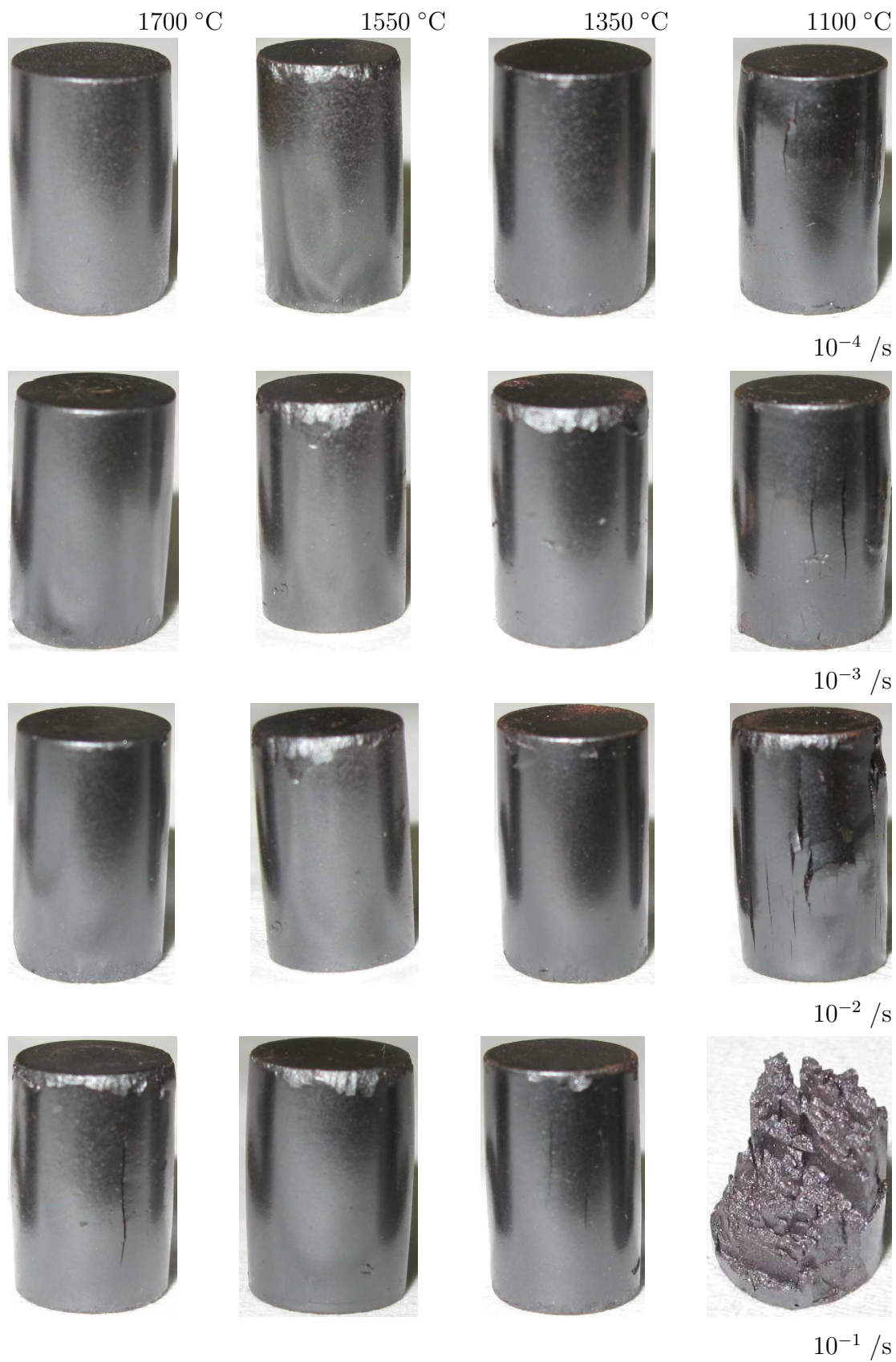
Figure 4.8. – Aspect des échantillons déformés du lot forte densité.
