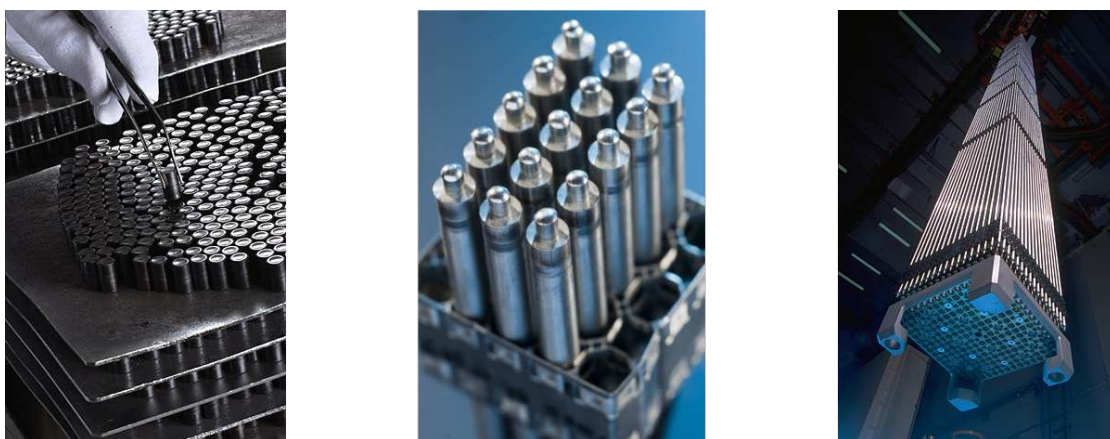
Figure 1.3. – Des pastilles combustibles (à gauche) à l'assemblage (à droite) en passant par le crayon (au centre).
