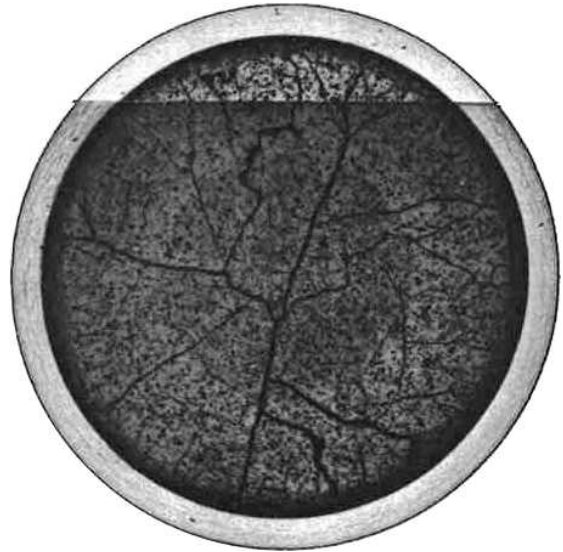
Figure 5.3. – Macropgraphies de coupes radiales des essais REP-Na issus de (Lespiaux 1997) .
