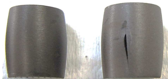
Figure 3.7. – Aspect des échantillons déformés avec et sans fissure.
