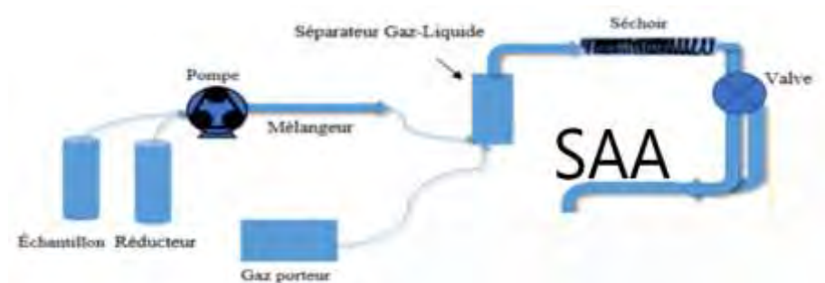
Figure 10: Dispositif SAA à vapeur froide
