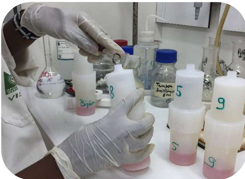
Figure 13: Ajout d'acide nitrique au niveau du tube collecteur
