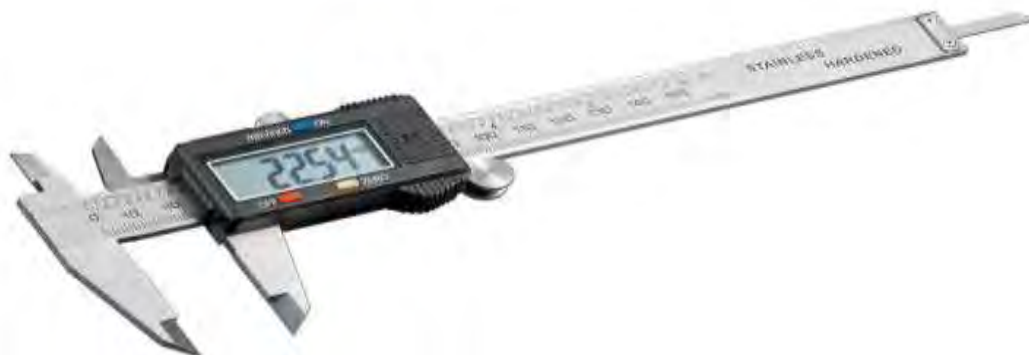
Figure 5 : Pied à coulisses Digital Caliper (150 mm)
