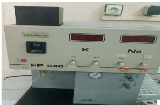
Photo 1: Spectrophotomètre émission de flamme
