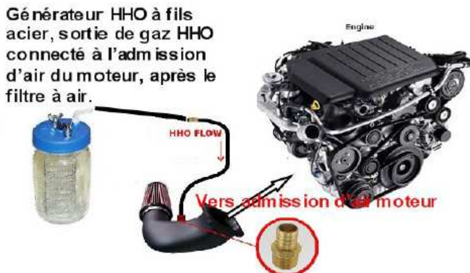
Figure 33 : Installation d'un générateur HHO [6]
