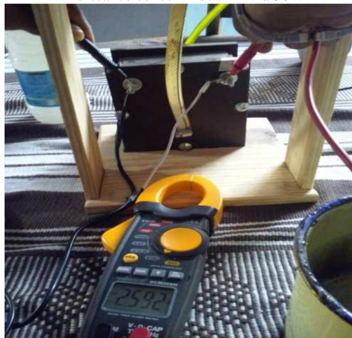
Figure 36° tension entre les électrodes
