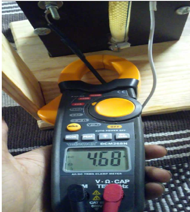
Figure 37° Courant d'alimentation du générateur HHO
