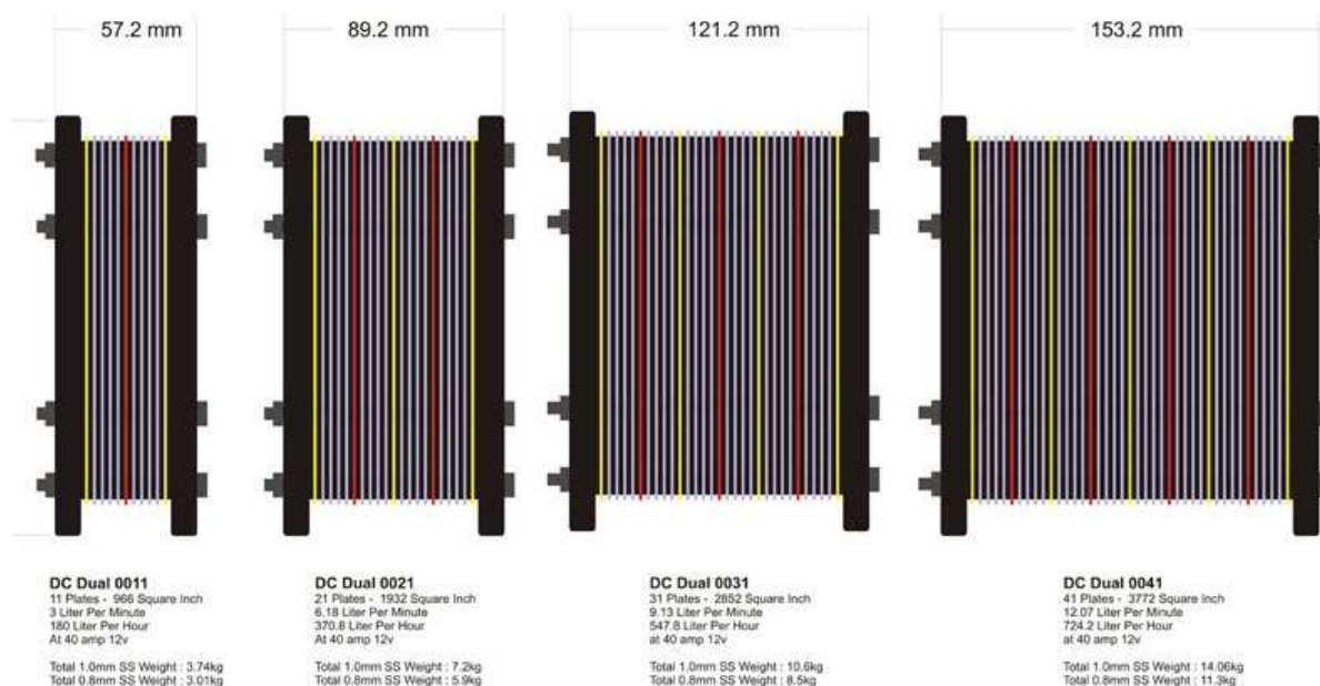
Figure 32 : Disposition des plaques d'un générateur HHO type Dry Cell [7]
