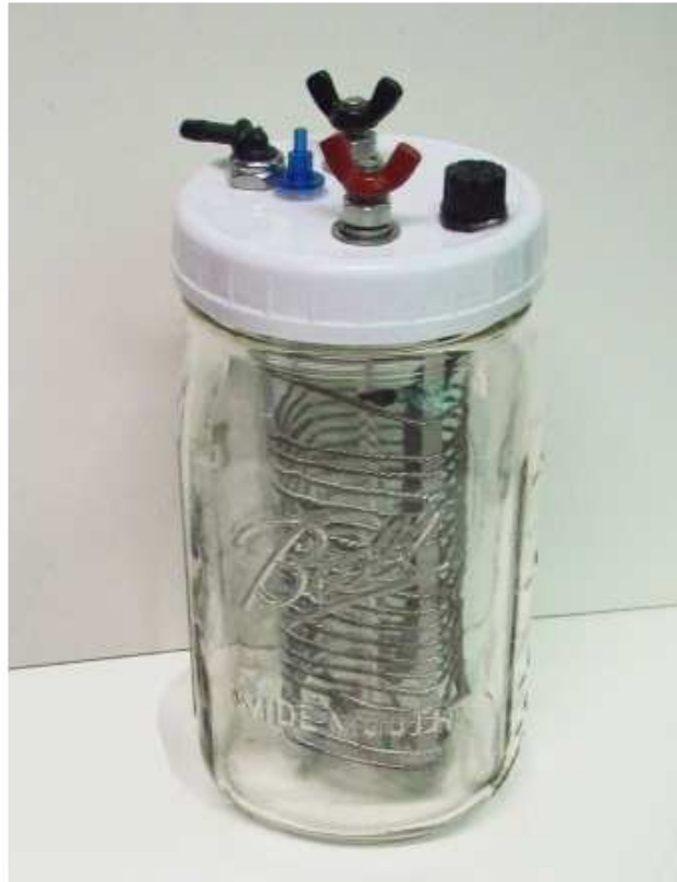
Figure 30 : Générateur HHO en bocal [9]
