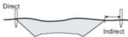
Figure 21: Les deux types de méthodes pour implanter une entrée en terre
