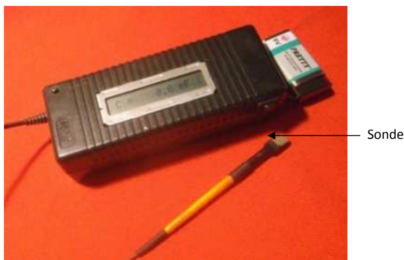
Figure 6. Cornéomètre utilisé pour mesurer la capacitance électrique de la peau.
