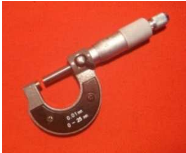
Figure 7. Palmer, appareil utilisé pour mesurer l'épaisseur de la peau
