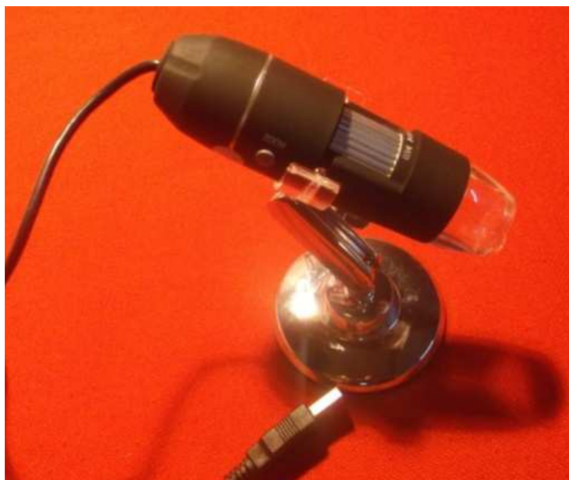
Figure 8. Loupe digitale utilisée pour observer le relief de la peau.
