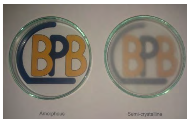
Fig. III-56 : Aspect visuel des films obtenus par évaporation de solvant du tribloc "PCL am ." 65 - b -Krasol H- b -"PCL am ." 65 (à gauche) et du PCL 70 - b -Krasol H- b -PCL 70 (à droite)
