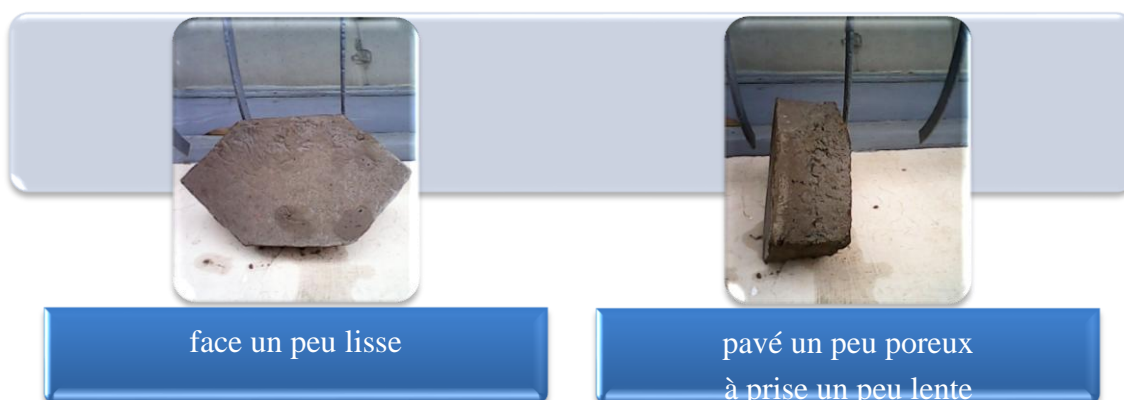
Fig. 32 : Images et interprétations de l'Essai №5 2
