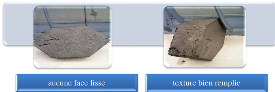
Fig. 25 : Images et interprétations de l'Essai №1 1
