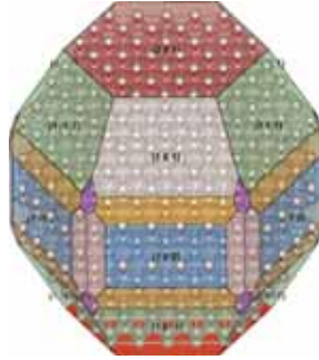
FIGURE 3.10: Construction de Wulff d'une nanoparticule de ruthénium hcp. Les différentes facettes sont mises en évidence par des couleurs différentes.
