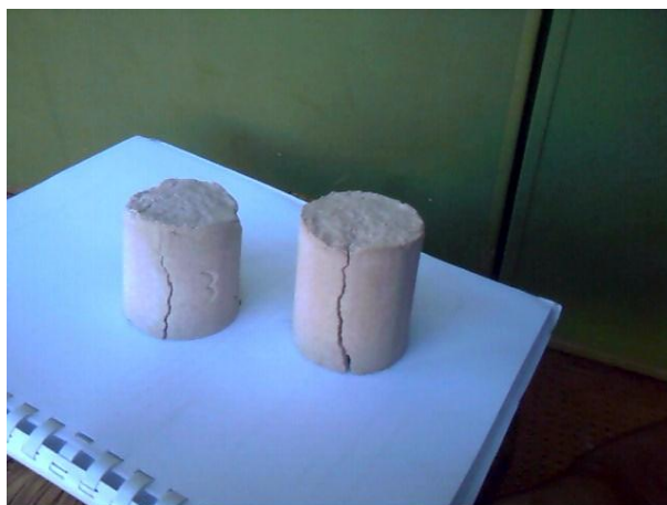
Figure 47 : Fissuration de l'éprouvette à cause du défaut de séchage
