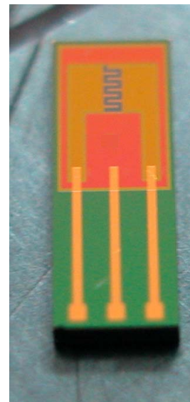
Figure 2.24: Photographie d'un ChemFET (structure "bâtonnet")
