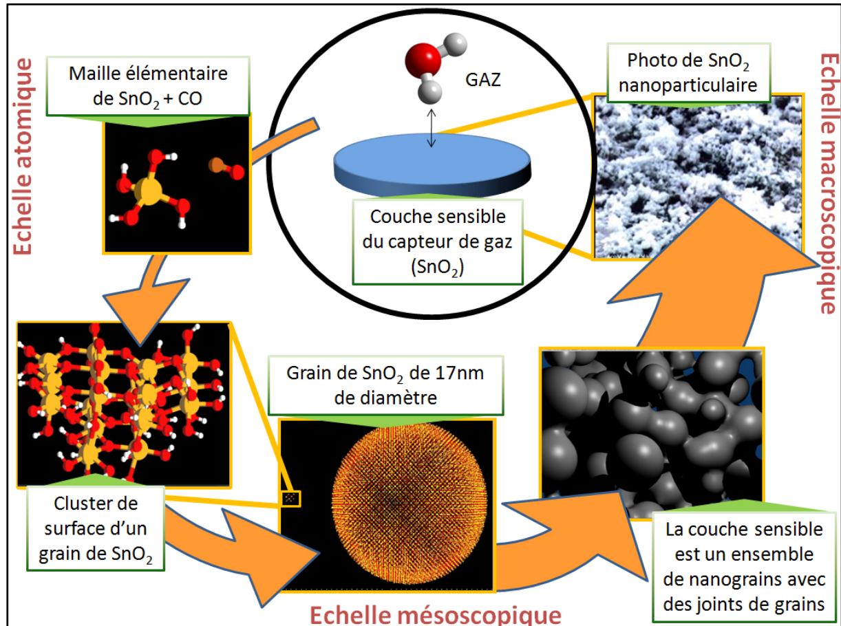
Figure 1 Les différentes échelles de la modélisation "Bottom-up" d'un capteur de gaz à oxyde métallique nanoparticulaire.
