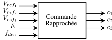
FIGURE 2.11 – Principe d'une commande rapprochée
