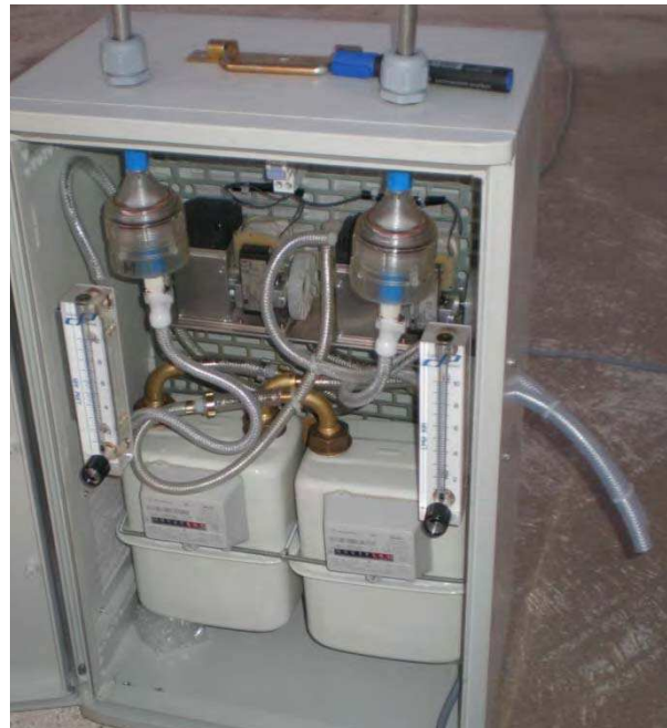
Figure VI.19 : Photos du préleveur d'aérosols
