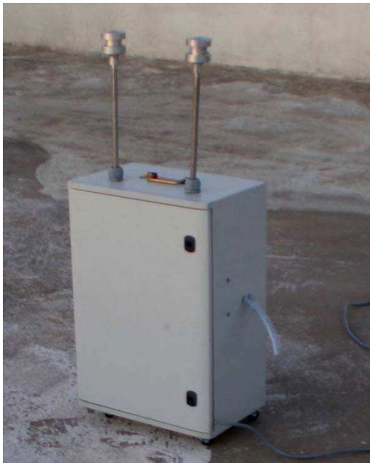
Figure VI.19 : Photos du préleveur d'aérosols
