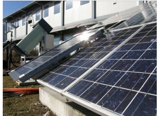
Figure 4.35 : Site expérimental de l'unité du CEA au Bourget-du-lac d'essais en ensoleillement réel du module LiPV.
