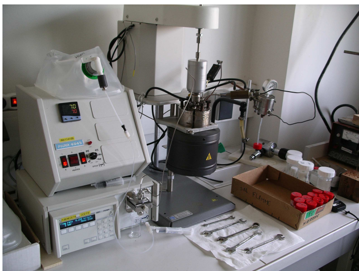
Figure V-7 : Dispositif expérimental utilisé pour les expériences de dissolution du NiO
