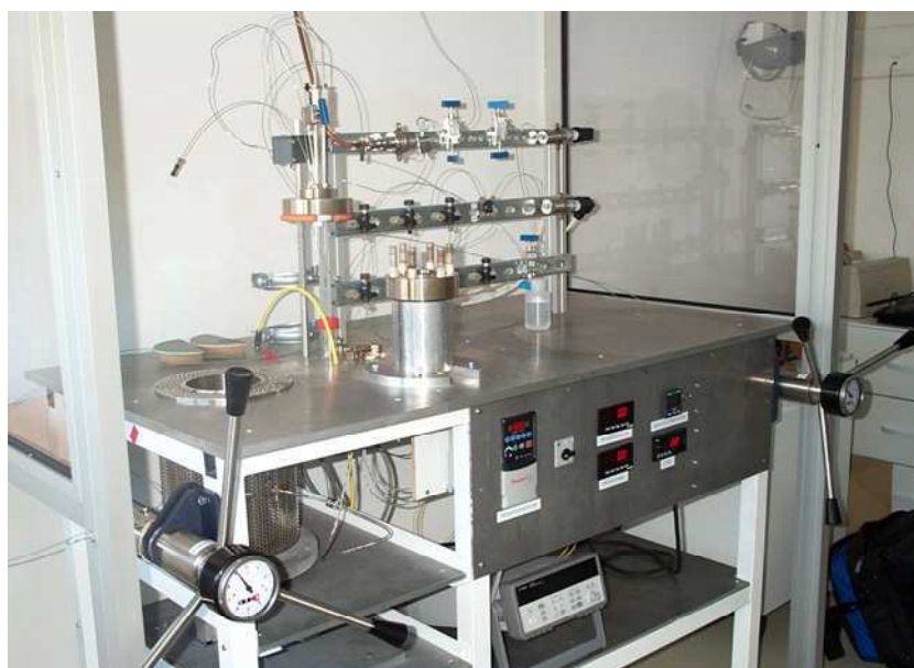
Figure IV-1 : Photographie du dispositif expérimental avant essai (réacteur hors du four)
