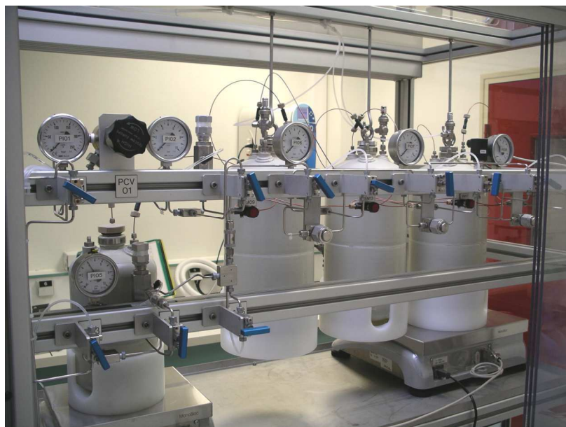
Figure II-3 : Photographie du circuit d'injection des gaz de conditionnement
