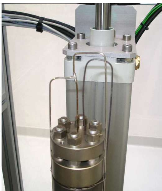
Figure II-6 : Photographie du mélangeur
