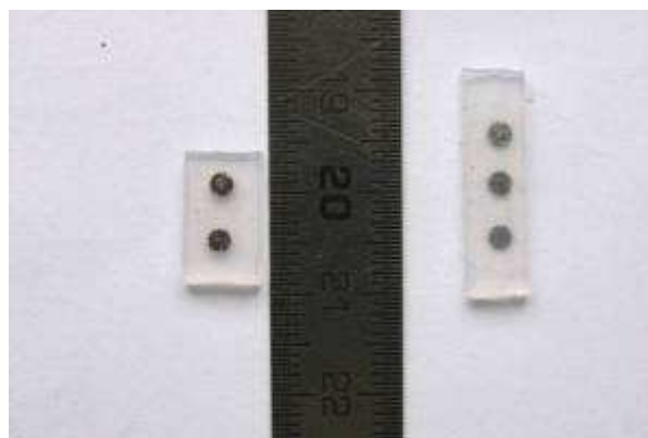
Figure III-29 : Bande aimantée moulée dans du silicone
