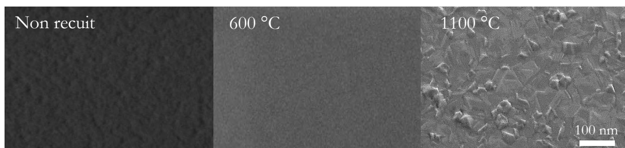
Figure 64 : vues au MEB ( \times 350\,000 ) de la surface de l'alumine déposé par ALD, non recuite, recuite à 600 °C et à 1100 °C 5 minutes sous O_2 .
