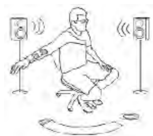
Figure 2-20 : illustration du système SleeveAR, l'utilisateur effectue un mouvement, il ne peut pas lire les informations visuelles (bras droit) qui sont hors de son champ de vision car le sujet gardait la tête droite pour ce mouvement de rééducation, un guidage audio et haptique prend le relais.
