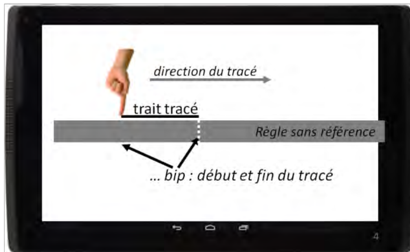
Figure 4-10 : illustration de la technique « Règle lisse ». Exemple d'utilisation : « je fais une double tape, j'entends un bip, je déplace doucement mon doigt vers la droite. Lors de mon déplacement, j'entends un bip, j'estime la valeur transmise ».
