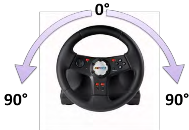
Figure 3-13 : illustration de la technique « volant ». Exemple d'utilisation « Je tourne doucement le volant à droite ou à gauche. Lors de ma rotation, j'entends un bip, j'estime la valeur transmise ».
