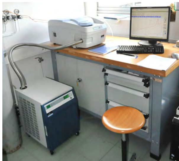
FIGURE 2.26 – Système d'analyse calorimétrique différentielle (ICA Albi)
