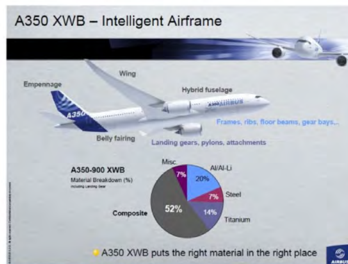
FIGURE 1.2 – Composition de l'Airbus A350 ©Airbus
