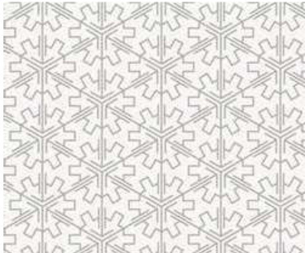
Fig 8.I Papier électromagnétiquement isolant composé de motifs périodiques[27].
