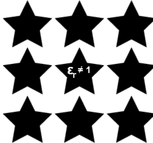
Fig 15.II Exemple de géométrie non canonique : coupe 2d d'un réseau de tiges en forme d'étoile.
