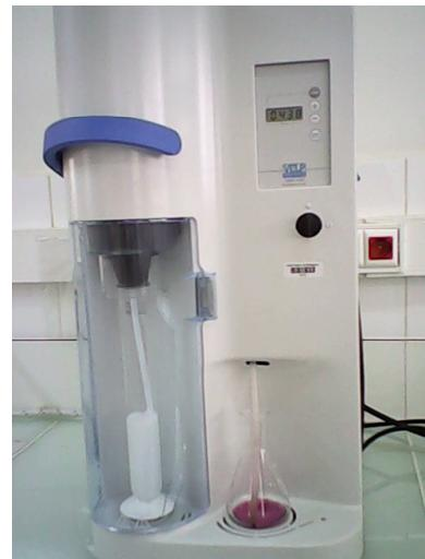
**Figure 7 : Distillateur de Kjeldahl (Source : auteur)**
