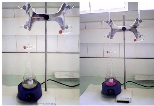
**Figure 8 : Titration du distillat (Source : auteur)**
