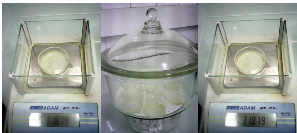
**Figure 10 : Détermination de la matière sèche (Source : auteur)**
