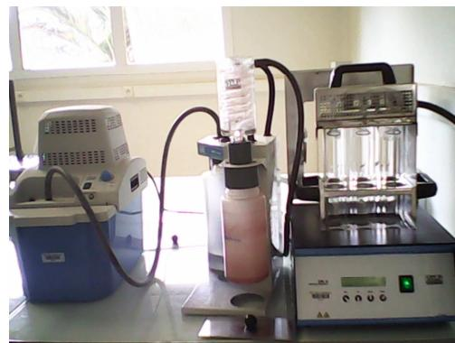
**Figure 6 : Digesteur de Kjeldahl (Source : auteur)**
