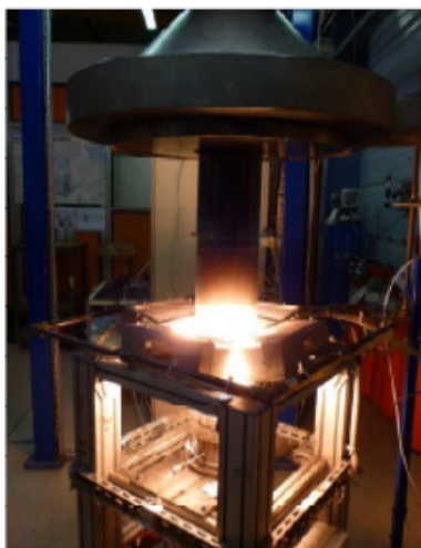
Figure 28 : Essais de combustion d'une cellule amorphes (Unisolar)
