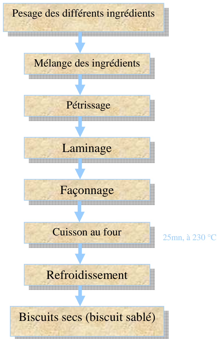
Figure 12: Diagramme de fabrication du biscuit à base de sorgho
