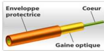
Figure 1.02 : Structure d'une fibre optique
