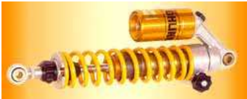
Figure 45 : Amortisseur type DE CARBON avec bombonne séparée
