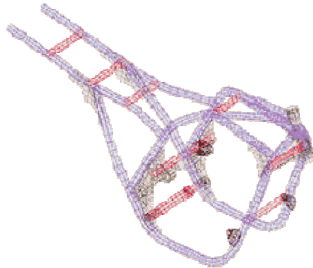
Figure 32 : Descriptif d'une cadre moto (Cadre Tubulaire: Honda Big One)
