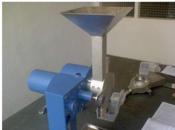
Figure 3 : Broyeur IK MF 10, vue de profil (Source : Auteur)
