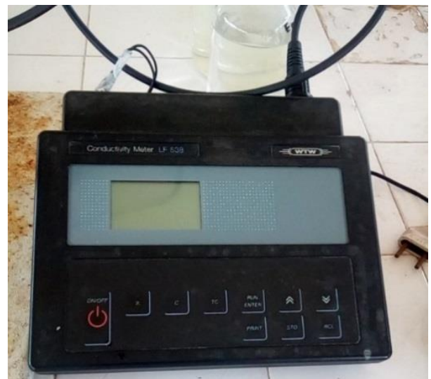
Photo 2:Conductimètre de laboratoire à multiple fonction « Modèle LF 538WTW »
