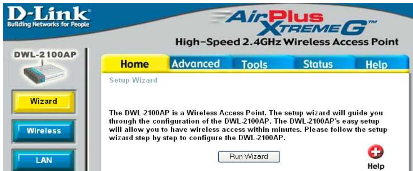
Figure 3.4 : Serveur web embarqué dans un AP
