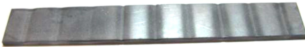
Figure 2.9 Epreuve en titane utilisée pour la répétabilité procédé
