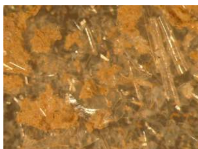
Figure 7 : Observation microscopique de la fraction supérieure à 40 µm des MES collectée à la station StC en milieu de Baie de Boulari, le 5-6 avril 2012 très forte présence de spicules carbonatées enrobées de particules éparses.
