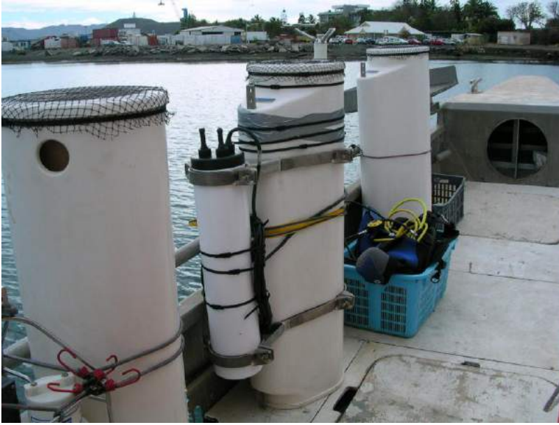
Figure 2 : Pièges à sédiment de type séquentiel (Technicap, modèle PPS4/3).
