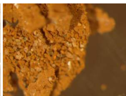
Figure 8 : Observation microscopique de la fraction supérieure à 40 µm décarbonatée des MES collectée à la station StA proche de l'embouchure de La Coulée, le 11-12 mars 2013 : présence de cristaux de quartz et de spinelle chromifères
