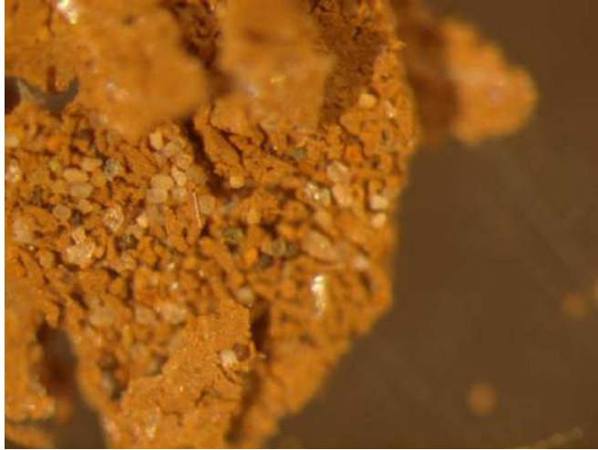
Figure 38 : Observation microscopique de la fraction supérieure à 40 µm décarbonatée des MES collectée à la station StA proche de l'embouchure de La Coulée, le 11-12 mars 2013 : présence de cristaux de quartz et de spinelle chromifères
