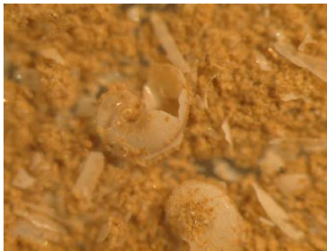
Figure 29 : Observation microscopique de la fraction supérieure à 40 \mu\text{m} des MES collectée à la station StA proche de l'embouchure de La Coulée, le 5-6 avril 2012 : présence de tests carbonatés de micro-organismes au milieu de particules terrigènes en forte proportion.
