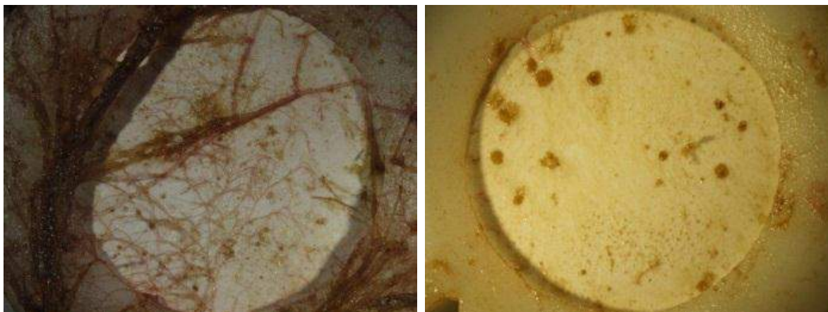
Figure 30 : Observations à la loupe binoculaire des structures biologiques constituant le biofilm après 28 jours d'immersion à la station Sèche Croissant, en saison chaude (gauche) et saison fraîche (droite) (grossissement x1).
