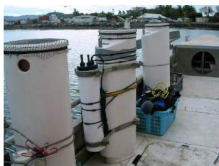
Figure 3 : Pièges à sédiment de type séquentiel (Technicap, modèle PPS4/3).
