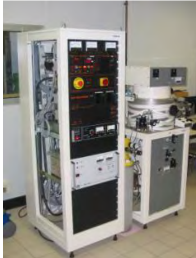
Figure II-7 : Bâti de pulvérisation cathodique ALCATEL CIT (modèle A450).
