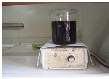
Figure N° 23 : Agitation de charbon actif dans la solution « bonbon+eau »
