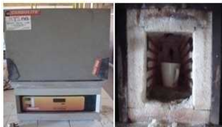
Figure N° 47 : Four de réactivation thermique du charbon actif en poudre
