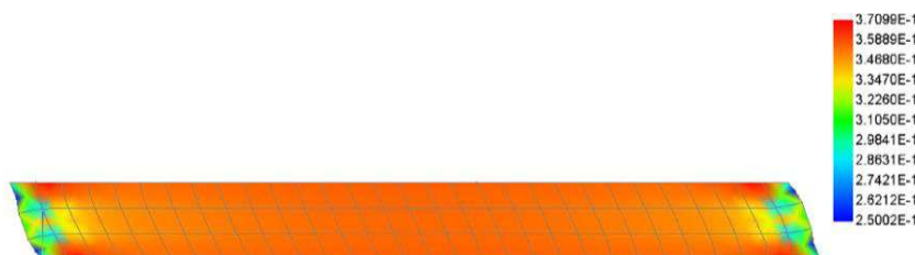
Figure 4-9 : Distribution du degré de réticulation \gamma = 50\%
