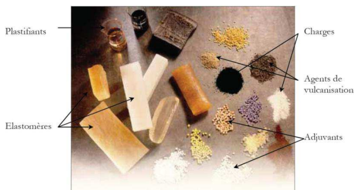
Figure 1-12 : Composition d'un mélange de caoutchouc [Koscher, 2003]
