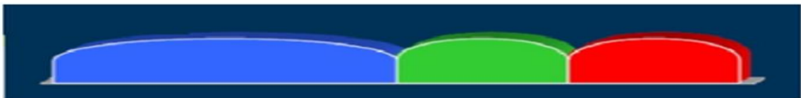
Figure 2.14..Spectre du mode localisé (choix retenu par le LTE par sa robustesse)
