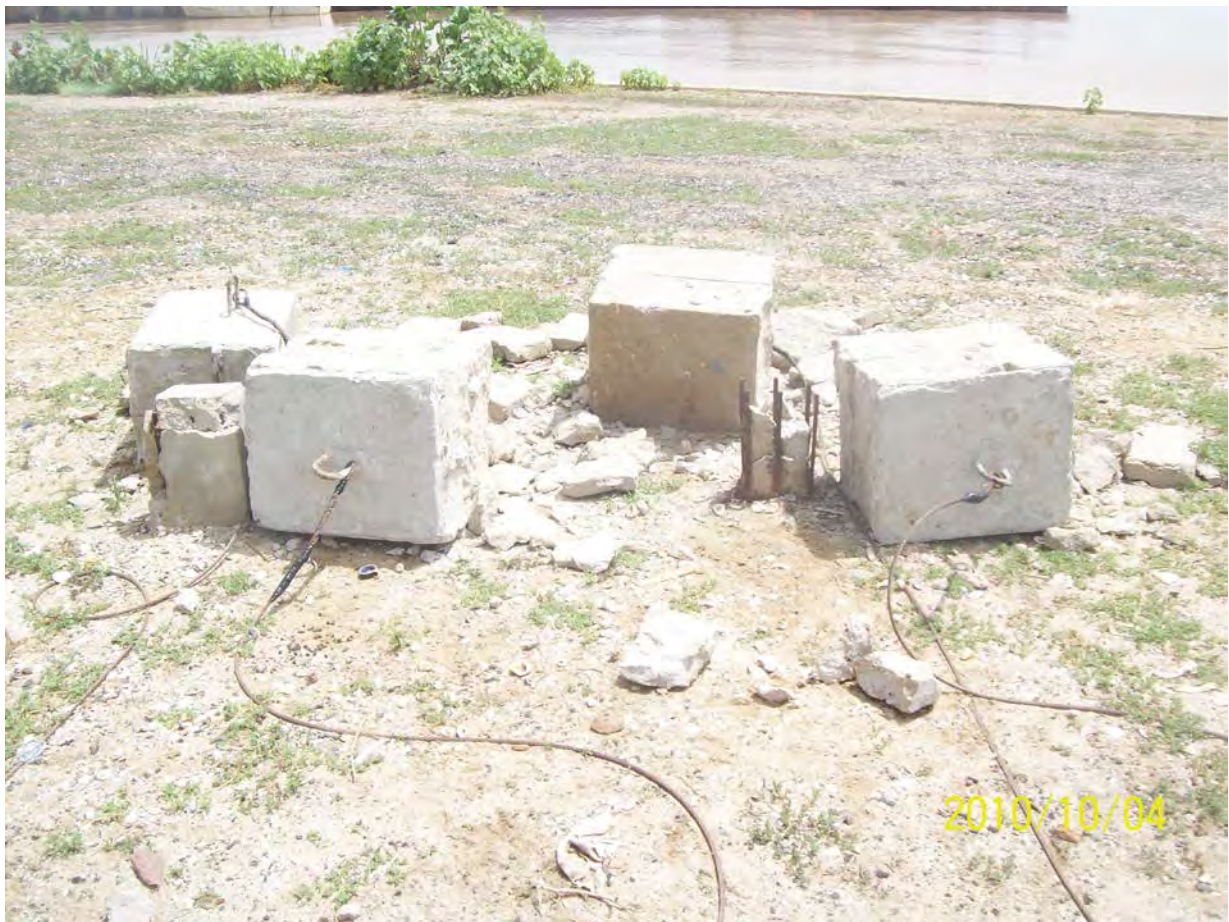
Cliché 2 : 4 lests (« geuz ») pour balise, ce qui permet de fixer la partie flottante de la balise (Aminata DIALLO 2010)
