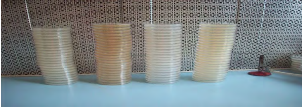
Figure 10 : Boites de pétri coulées avec les différents milieux de cultures : respectivement de la gauche vers la droite : PDA, MEA, Dox, SB
