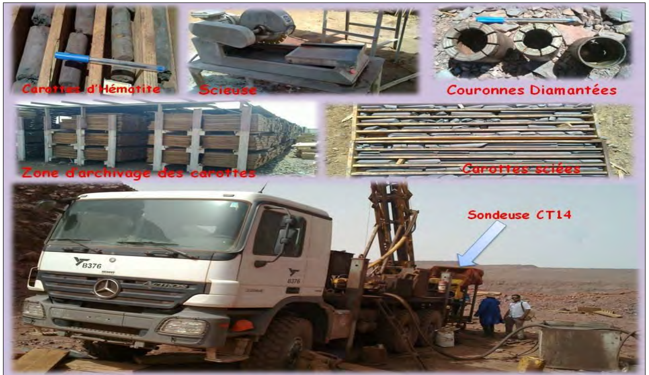
Figure3.1 : récapitulatif des opérations du sondage carotté
