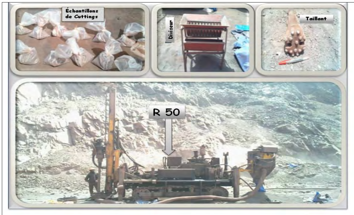
Figure3.3 : récapitulatif des différentes opérations du sondage percutant
