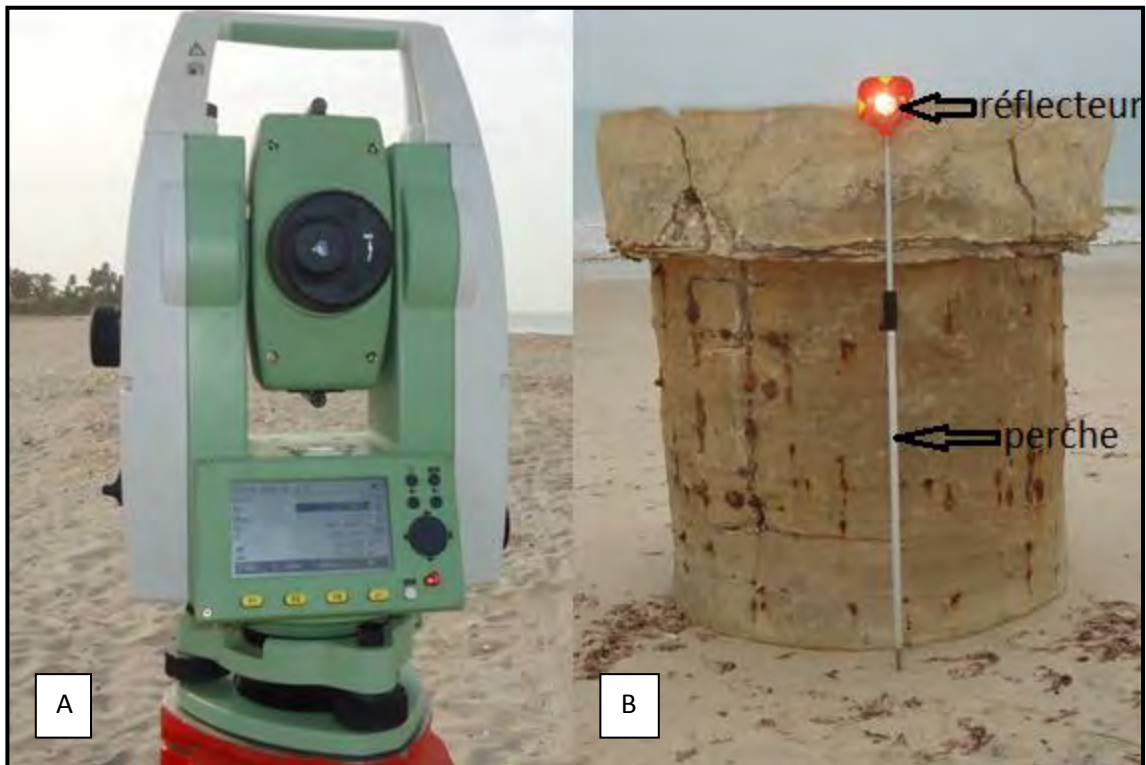
Photo 2 : matériels d'acquisition de données topographiques (station totale (A) et son réflecteur (B))
