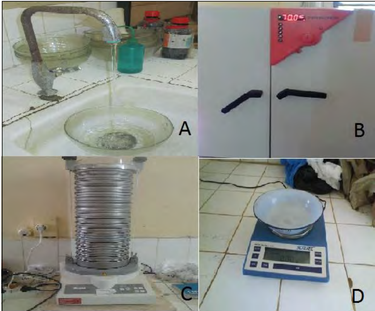
Photo 4 : Dispositif de traitement des échantillons de sables au laboratoire (robinet (A) ; étuve Binder (B) ; colonne de tamis de norme AFNOR et tamiseuse (C) ; balance électrique de précision (D))
