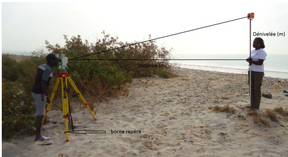
Photo 3 : principe de réalisation d'un profil topographique
