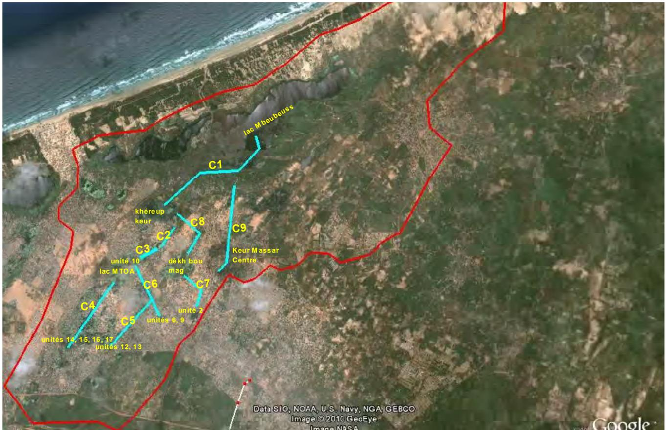
**Figure 14: Canaux de drainage du bassin versant de Mbeubeuss (Source : ADM)**
