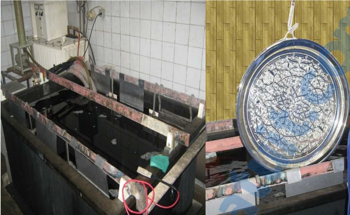
Fig.10 : Bain d'argent et pièce argentée
