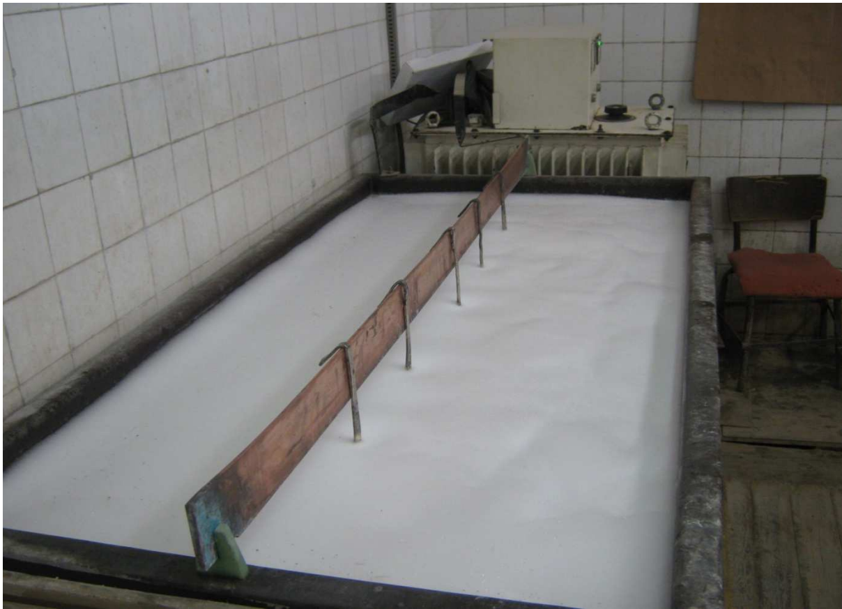
Fig.5 : Bain de dégraissage
