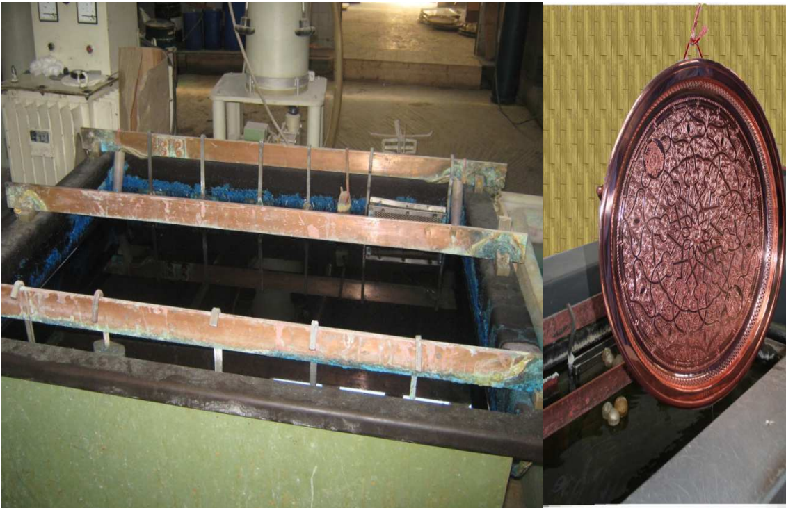
Fig.7 : Bain de cuivre acide et d'une pièce cuivrée
