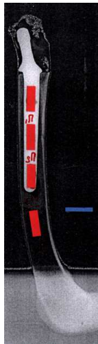
Annexe 30 : Déformation médiale du tibia pour la prothèse Amplitude de taille 4, enregistrées par jauges d'extensométrie. Les valeurs à gauche sont les valeurs des déformations lors de mise en charge maximale.
