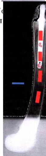
Annexe 14 : Déformation médiale du femur pour la prothèse Amplitude de taille 2, enregistrées par jauges d'extensométrie. Les valeurs à gauche sont les valeurs des déformations lors de mise en charge maximale.
