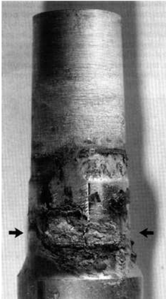
Photo 1 : Image de corrosion à l'interface métal-métal d'un clou centromédullaire modulaire (47).
