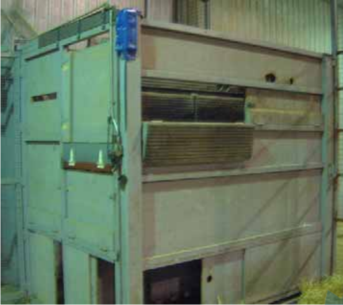
Figure 62 : Cage de contention pour girafes présentant de nombreux panneaux amovibles (photo : Dr Clément LANTHIER).
