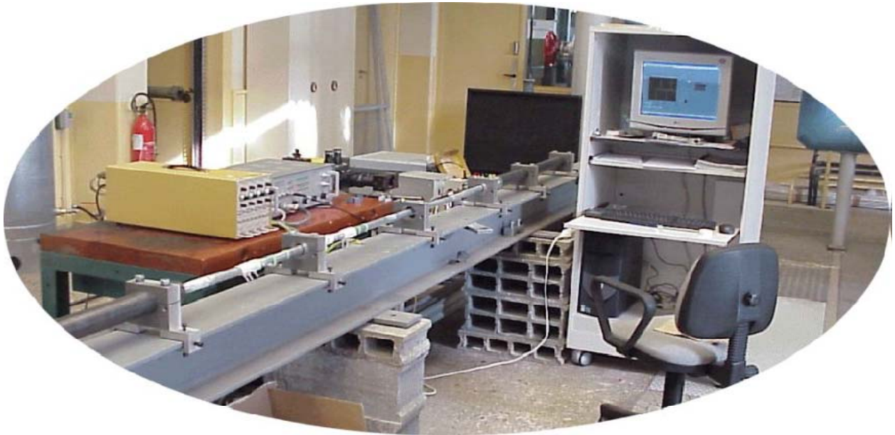
Figure 1.17: Le dispositif à barres d'Hopkinson [31].
