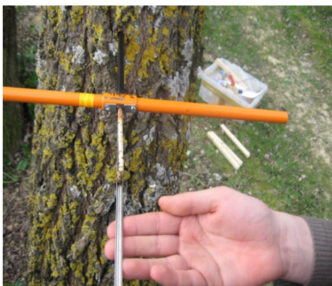
Photo 3.1:Prélèvement de la carotte avec une de Tarière de Presler
