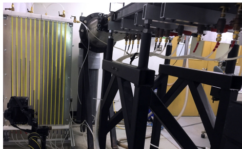
FIGURE 2.6 – Disposition du manomètre à colonnes d'eau par rapport à la veine d'essai et positionnement de l'appareil photo.
