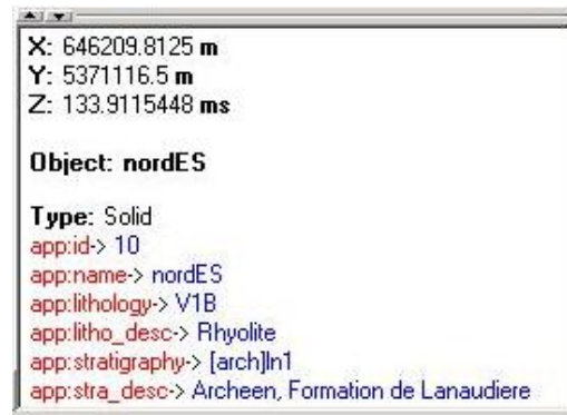
Figure 20 : Exemple de fenêtre du plug-in Gocad montrant les propriétés descriptives d'un solide.
